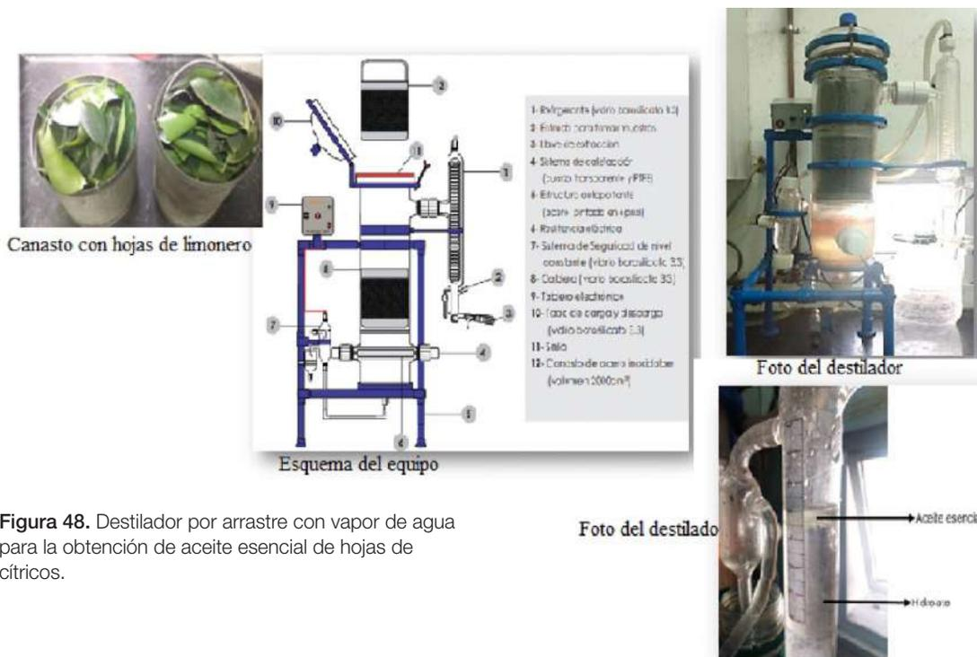
**Figura 48.** Destilador por arrastre con vapor de agua para la obtención de aceite esencial de hojas de cítricos.
