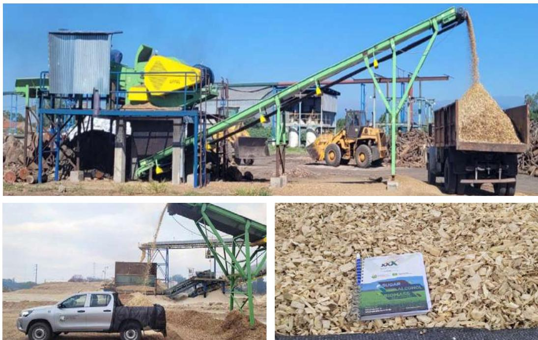
**Figura 71.** Ensayo en chipeadora fija Lippel.
