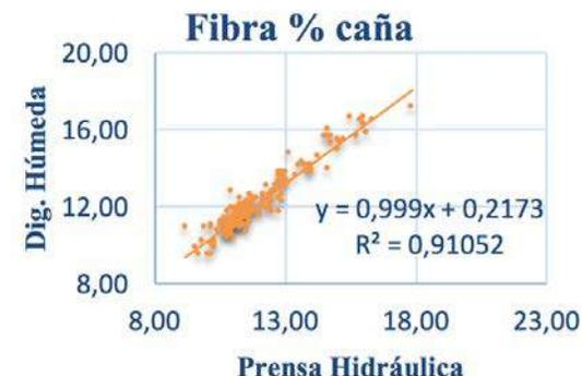
**Figura 38.** Comparación de métodos de prensa hidráulica y digestión húmeda. Regresión lineal para pol % caña y fibra % caña. Ensayos realizados en 187 muestras.
