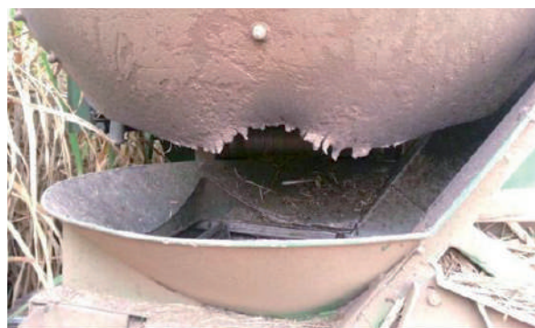
Figura 18. Cola de pato dañada que puede generar pérdidas de caña troceada. Tucumán, 2016.
