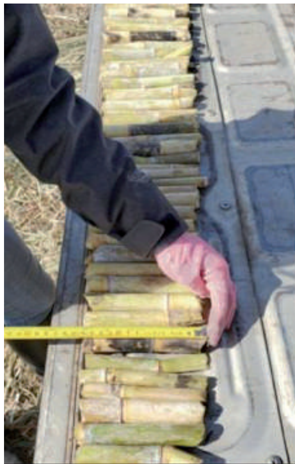
Figura 22. Medición del largo del troceado, Tucumán, 2021.
