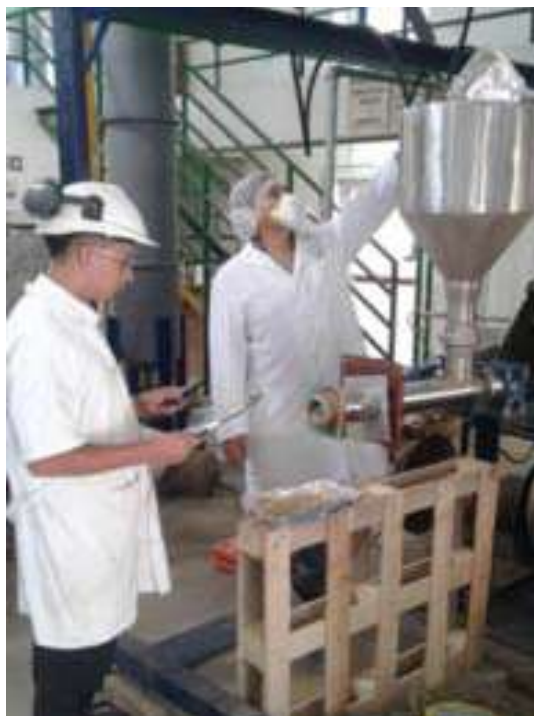
Figura 55. Ensayos del sistema de alimentación de biomasa al reactor.
