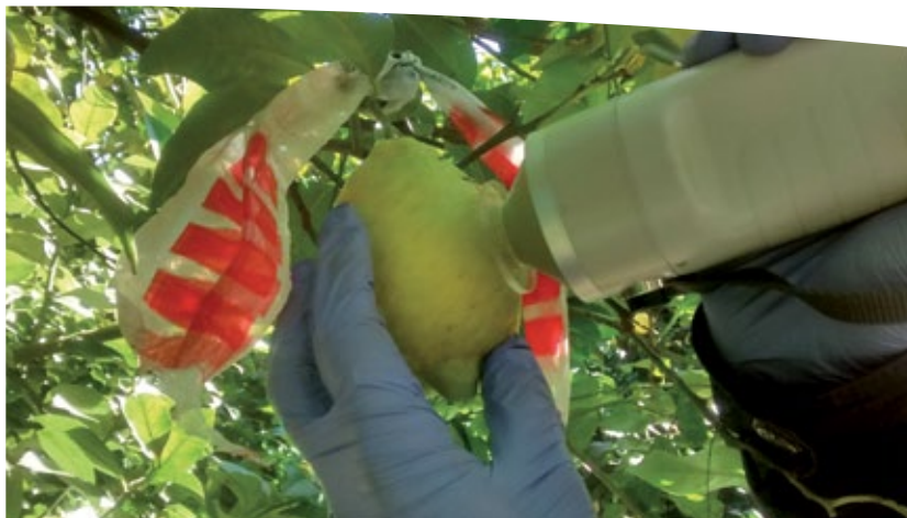
Determinación del Índice de color en cítricos (ICC) a campo mediante colorímetro.
