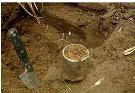
Figura 23. Determinación de la densidad aparente en distintos marcos de plantación.
