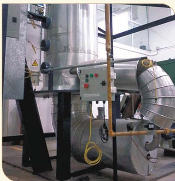
**Figura 58.** Equipo piloto para la gasificación de los residuos de la cosecha de la caña de azúcar (RAC).
