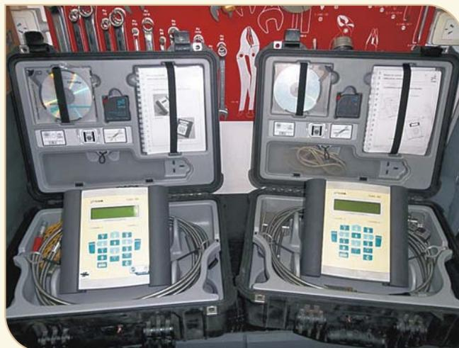
**Figura 53.** Nuevos medidores portátiles de flujos líquidos por ultrasonido.
