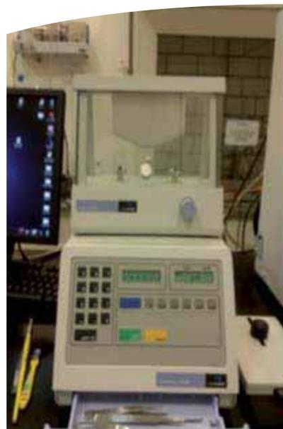
Figura 7. Equipo analizador elemental de combustible, instalado en el NEST-UNIFEI.
