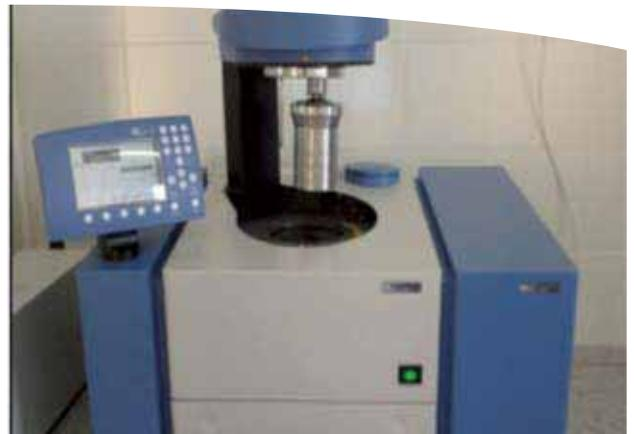
Figura 4. Bomba calorimétrica automatizada, marca IKA, modelo C5000, instalada en LEMI-EEAOC.
