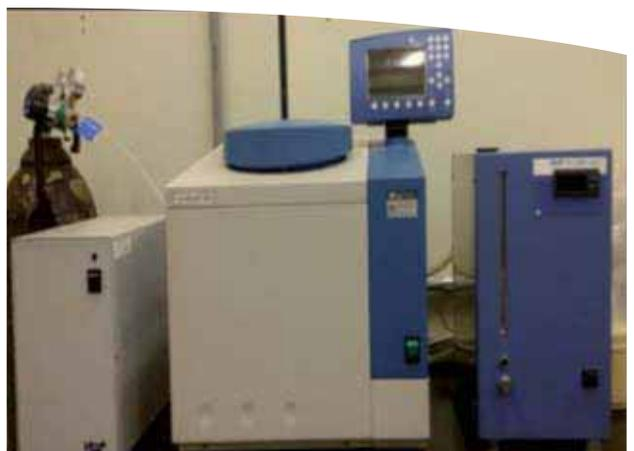
Figura 6. Bomba calorimétrica automatizada, marca IKA, modelo C2000, instalada en NEST-UNIFEI.
