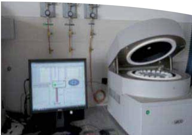
Figura 3. Equipo TGA instalado en el LEMI-EEAOC.
