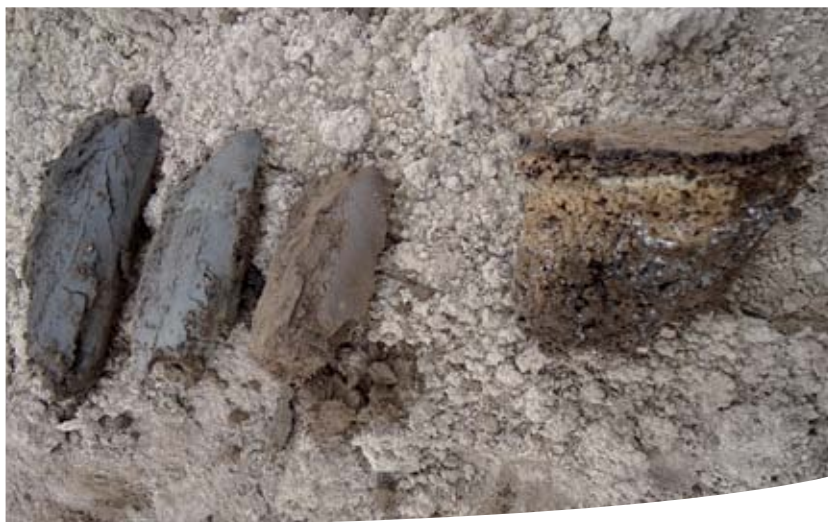
Situación negativa. Muestras de suelo a 0-30 cm (izquierda), 30-60 (centro) y 60-90 (derecha), 30 días después de finalizada la aplicación de 6000 m 3 /ha/año. Vista lateral de los primeros 15 cm de suelo.
