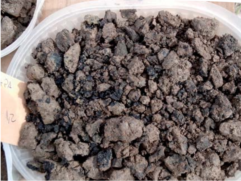
Situación negativa. Muestras de suelo a 150 cm de profundidad en sitio hasta donde la vinaza infiltró líquida 30 días antes del muestreo. Lámina anual de aplicación 6000 m 3 /ha.
