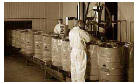
Proceso de envasado de aceite esencial de limón en recipientes metálicos inoxidables de 205 litros.
