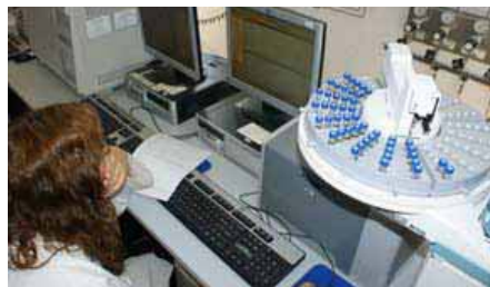
Vista de un cromatógrafo con inyección automática en los laboratorios de la EEAOC.
