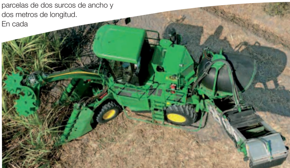
Figura 1. Radio de giro reducido en la cosechadora John Deere CH330
