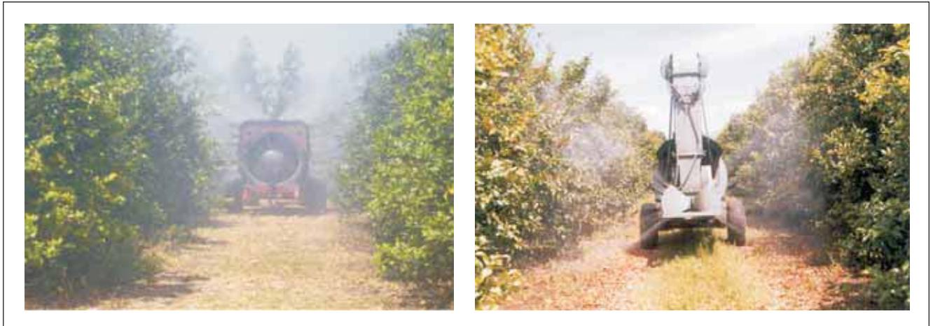
Figura 2. Máquinas pulverizadoras utilizadas para los tratamientos de alto, medio (izquierda) y bajo volumen (derecha) en fincas cítricas de la provincia de Tucumán (R. Argentina).
